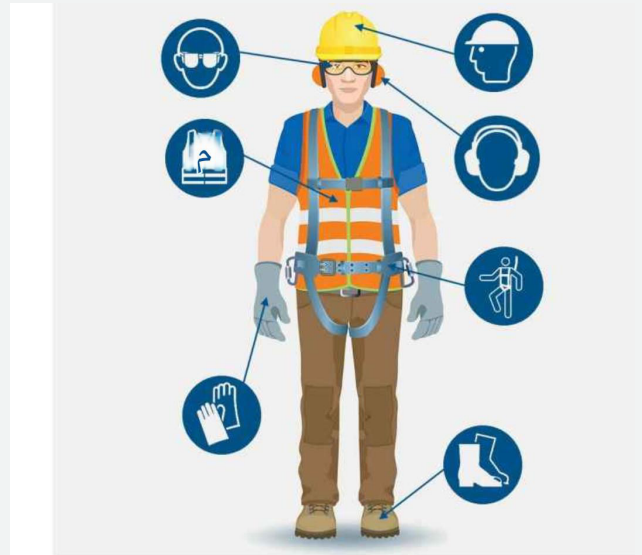
شکل ۱. تجهیزات حفاظت فردی (PPE).
